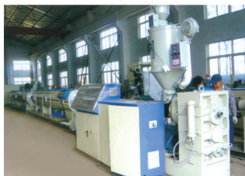
FRPP PP 管材生产线
